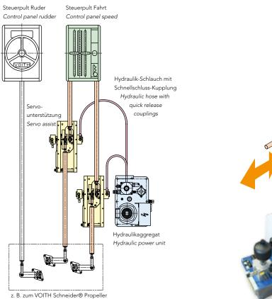
z. B. zum VOITH Schneider® Propeller e. g. to the VOITH Schneider® Propeller
